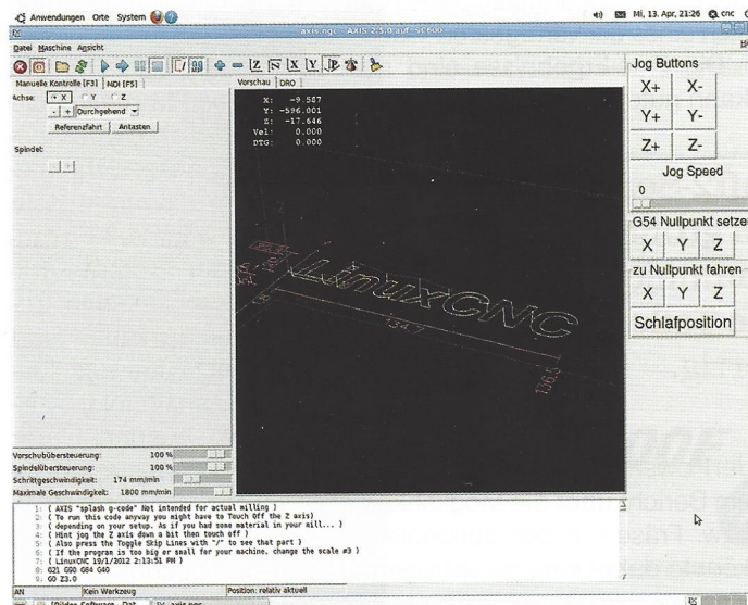
DIE Startoberfläche von LinuxCNC; die Software funktioniert perfekt mit der Stepcraft-Fräse.
