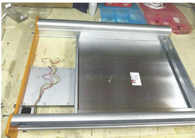
Die Montage des Unterbaus. Die beiden Y-Führungen sind montiert und mit einem Schrittmotor versehen.
