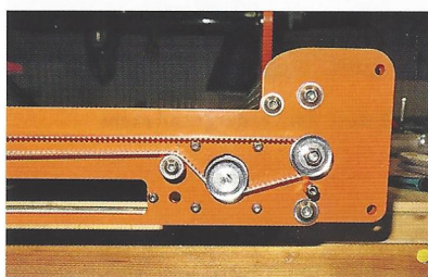
Selbst die Riemenumlenkung der Y-Achse ist einfach zu montieren und auszurichten.
