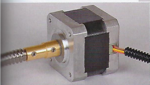
Motor mit Achsverbinder, Gewindestiften, Spindel und Anschlusskabel
