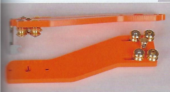
Seitenteile des Portals mit Lauf- rollen, Spindelmutter und Kabelführung
