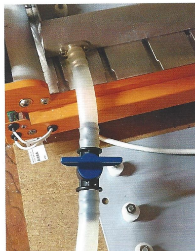
Der beiliegende Schlauch wird geteilt und der Absperrhahn eingesetzt.
