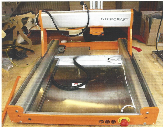
Vorbereitung des Einbaus der Nutenplatte: Der vordere Halterung wird entfernt und die Holzplatte herausgezogen.
