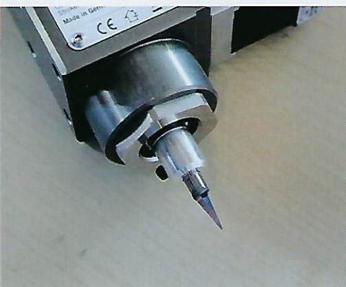
Die Klinge wird zwar nur wenig bewegt, dies aber mit bis zu 2.000 Hübten pro Minute
