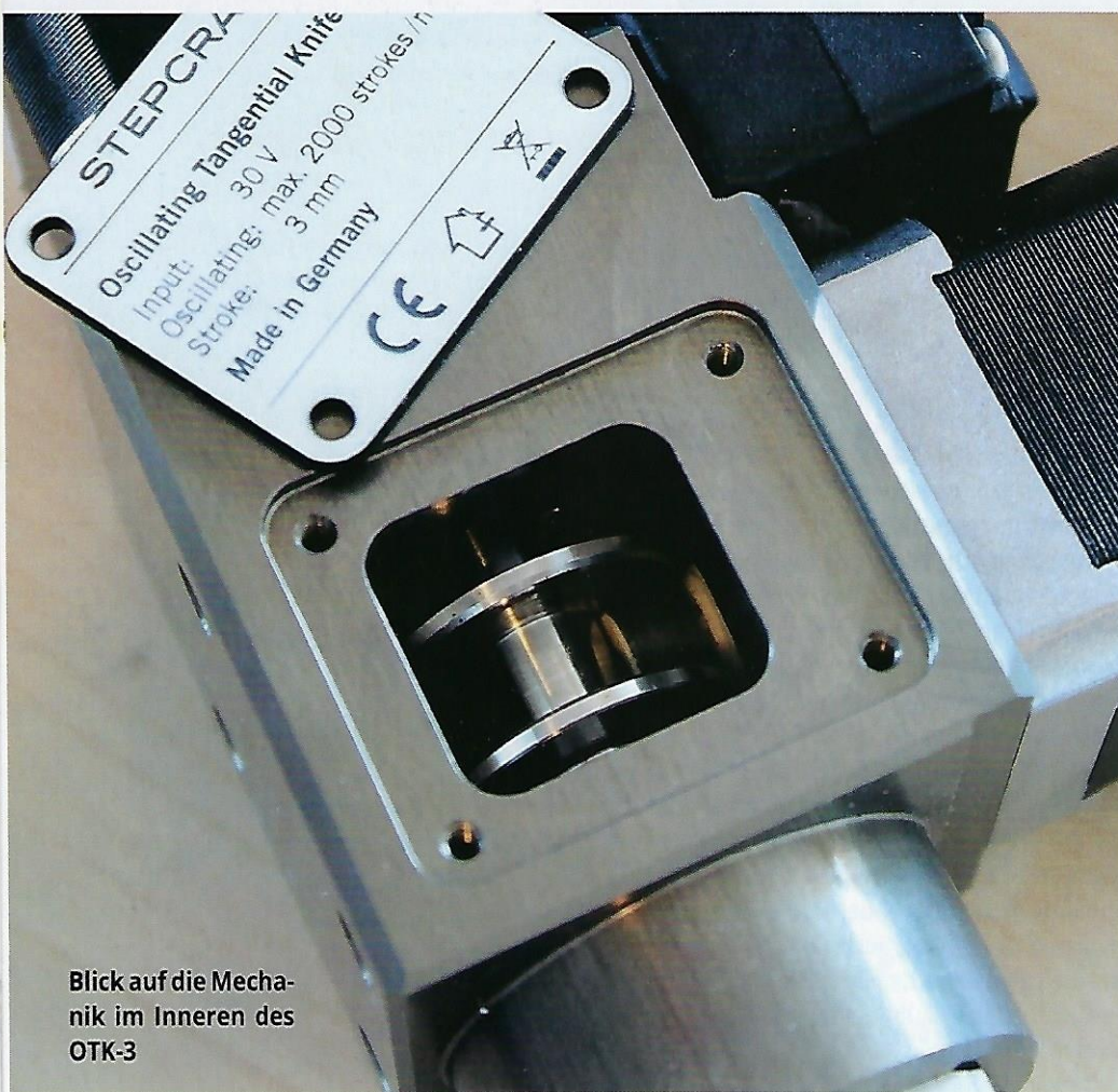
Die Klinge wird zwar nur wenig bewegt, dies aber mit bis zu 2.000 Hübten pro Minute
