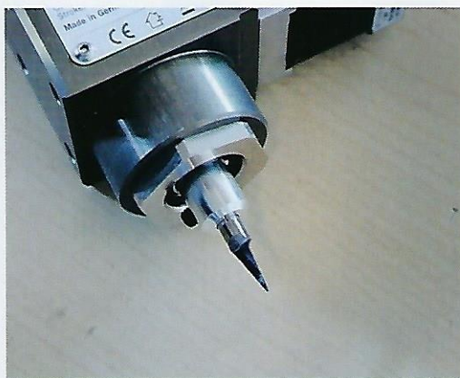
Die Klinge wird zwar nur wenig bewegt, dies aber mit bis zu 2.000 Hübten pro Minute
