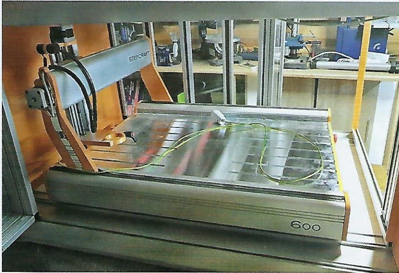
Die Fräse wird von der Seite aus hineingeschoben.
