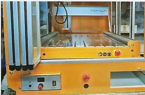
Unten links ist die Steuereinheit der HF-Spindel zu sehen.
