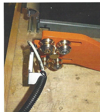
Die vier Führungsrollen für die Y-Achse im Detail.
