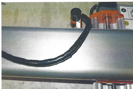
Statt des mitgelieferten Kabelschlauchs habe ich Spiralschlauch (oben) verwendet – hält genauso gut, ist aber deutlich einfacher aufzufädeln.
