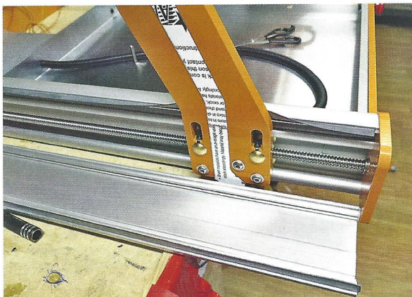
Zur Wartung aufklappbar: die Y-Achse. Die Kabel sind in einer Nut hinter den »Aufklebern« verschwunden.
