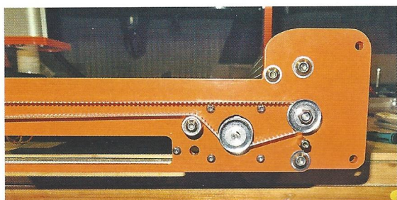
Die Riemenumlenkung der Y-Achse. Selbst diese ist einfach zu montieren und auszurichten.
