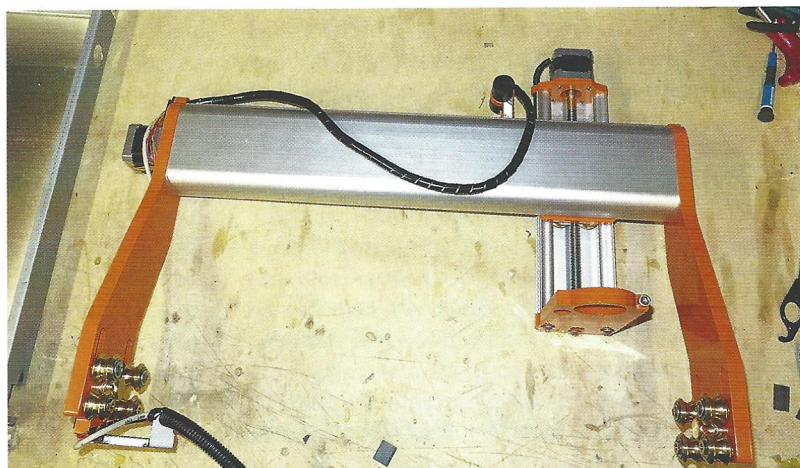
Die Montage des Portals mit der eingesetzten X-Z-Einheit.
