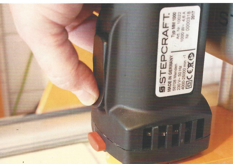
Beim Einschalten bewegt man den länglichen Schiebeschalter gegen einen Federwiderstand, ...
