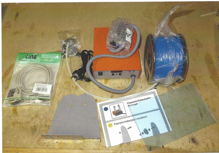
Mit dem übersichtlichen Teilesatz für den 3D-Drucker-Betrieb lässt sich die Stepcraft-2/600 innerhalb kurzer Zeit umrüsten.
