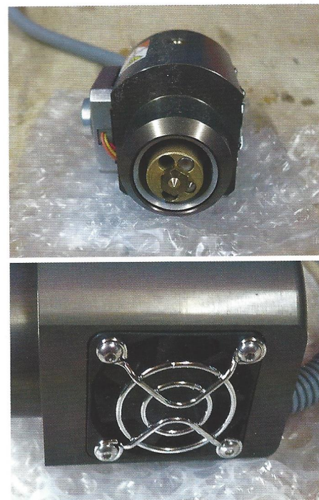
Innerhalb der Druckeinheit ist eine Düse montiert, die zwecks Austausch bzw. Reinigung schnell herausgeschraubt werden kann. Um dem bekannten Filament-Stau entgegenzuwirken, ist ein ordentlicher Lüfter verbaut.
