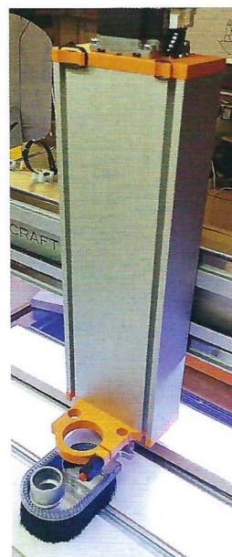
Alles wirkt industrieller: Die Z-Achse und der optionale Absaugadapter für die M.-Serie.
