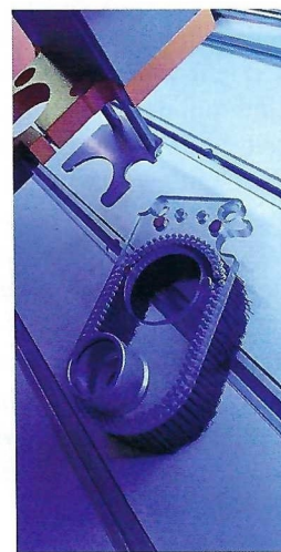
Auch genial, wenn auch optional: Der universelle Absaugadapter wird an einem beweglichen Rahmen unter der Z-Achse magnetisch gehalten.
