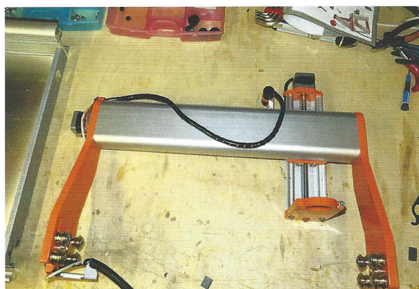
Montage des Unterbaus: Die beiden Y-Führungen sind eingebaut und mit einem Schrittmotor versehen (Bild ganz links).
