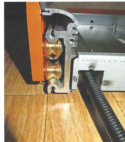
Die Y-Achse sitzt sauber in der Führung.
