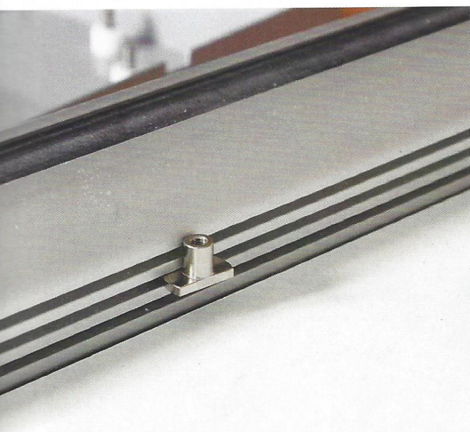
Zur Befestigung der Wanne werden spezielle Profilhaltermuttern in das Maschinenseitenprofil gesteckt – daran wird die Wanne mittels Schrauben befestigt.
