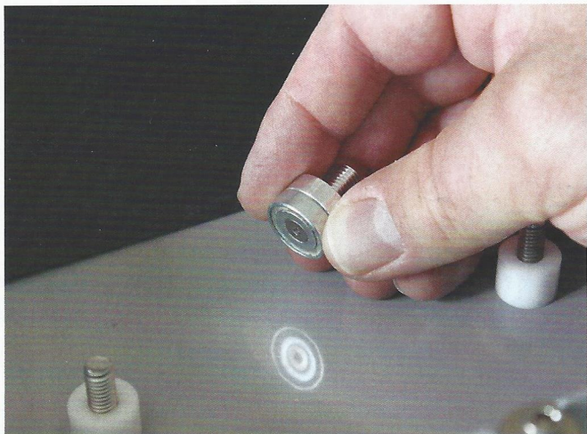
Platten mit anderen Maßen können mittels Magnetstützen gespannt werden. Diese haften dank eines starken Magneten hervorragend.
