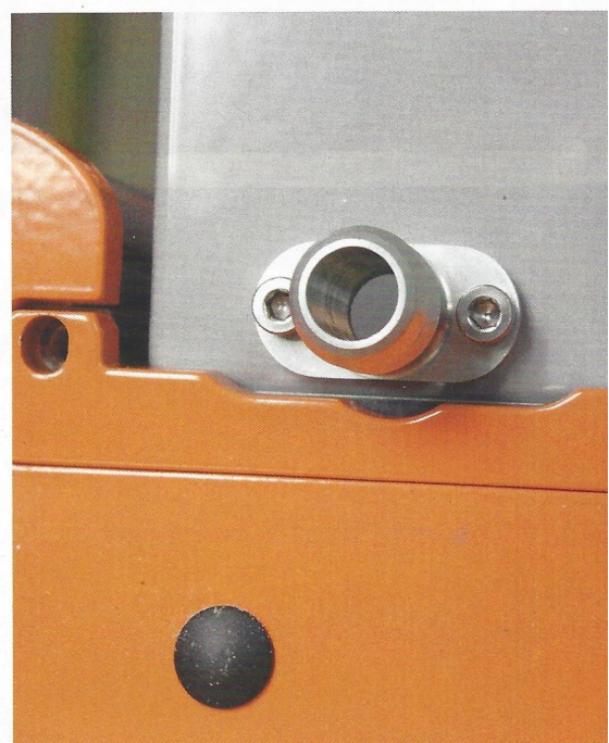
Damit der Riegel des Maschinentisches nicht in Konflikt mit dem Wasserauslass kommt, wird ein neuer, speziell angepasster verwendet.
