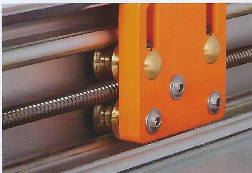
Die Y-Achse der Stepcraft 2/420 wird auf Rollen über Führungsschienen geführt. Zwischen den Rollen verläuft die Gewindestange. Die Spindelmutter, die auf der Gewindestange aufgeschraubt ist, liegt hinter der orangefarbenen Halterung.
