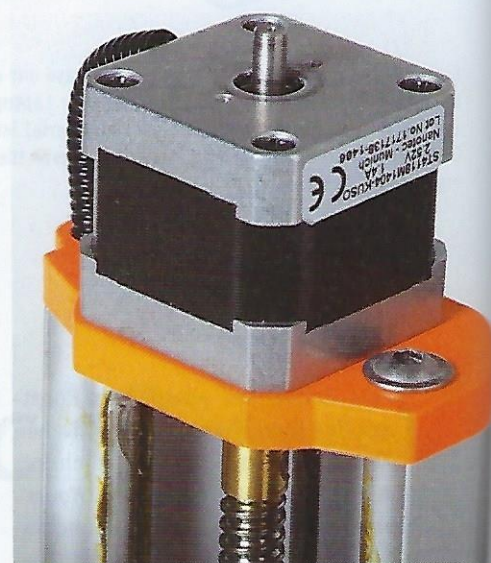
Auf dem oberen Ende der Z-Achse ist ein Schrittmotor montiert, der mit der Gewindestange verbunden ist. Die Motorrotation überträgt sich auf diese Gewindestange, die wiederum die Z-Achse bewegt.
