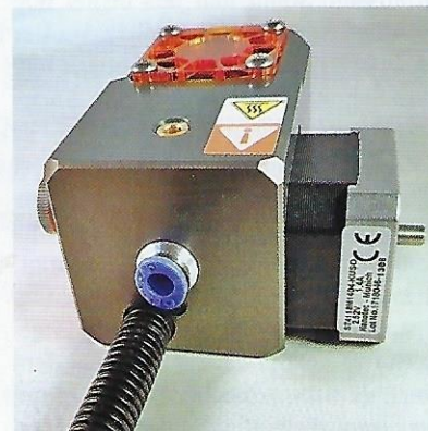
Noch fehlt das PTFE-Röhrchen in der Durchführung zur Druckeinheit.
