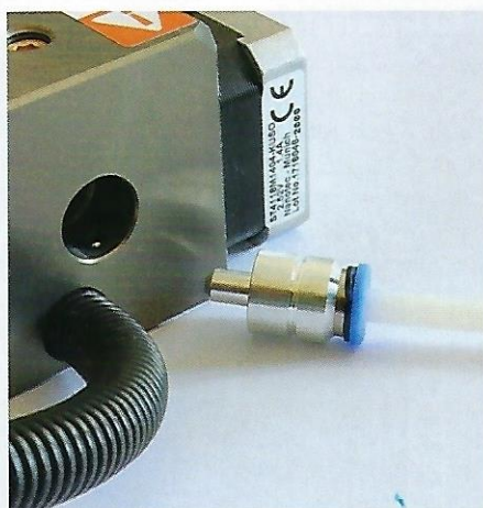
Der Zuleitungsschlauch mit dem Filamenteingang lässt sich aus dem Druckkopf entnehmen
