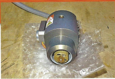
Der komplett verkabelte Druckkopf von unten. Die in der Druckeinheit montierte Düse lässt sich schnell zum Austausch oder zur Reinigung demontieren.
