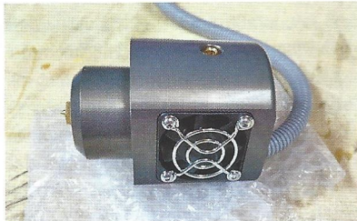
Um den bekannten Filament-Stau zu verhindern, ist ein ordentlicher Lüfter verbaut.
